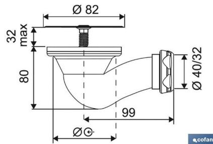
Válvula sifônica para placa de ducha com orifício de 60 mm. Grade de 82 mm feita de aço inoxidável de alta qualidade que garante durabilidade perfeita. Alta capacidade de vazão de drenagem. Tem uma tomada de saída de 40 mm e uma junta cônica redutora de 32 mm. Fabricada em PP de alta qualidade e materiais anti calcários que permitem uma maior duração e menor desgaste.
