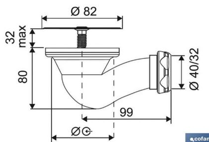
Vanne siphonique pour douche avec trou de 60 mm. Grille  $\varnothing 82$  mm en acier inoxydable de haute qualité qui garantit une parfaite durabilité. Débit de vidange élevé. Il a une prise de sortie  $\varnothing 40$  mm et un joint conique réducteur  $\varnothing 32$  mm. Fabriqué en PP de haute qualité et des matériaux anti-calcaires qui permettent une plus longue durée de vie et moins d'usure.
