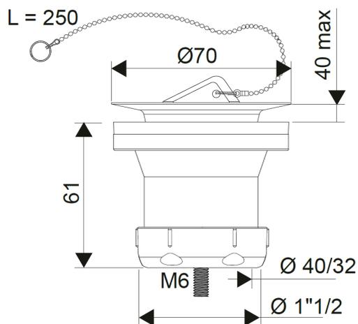
Válvula de lavatório bidé fabricada em polipropileno de alta qualidade.
