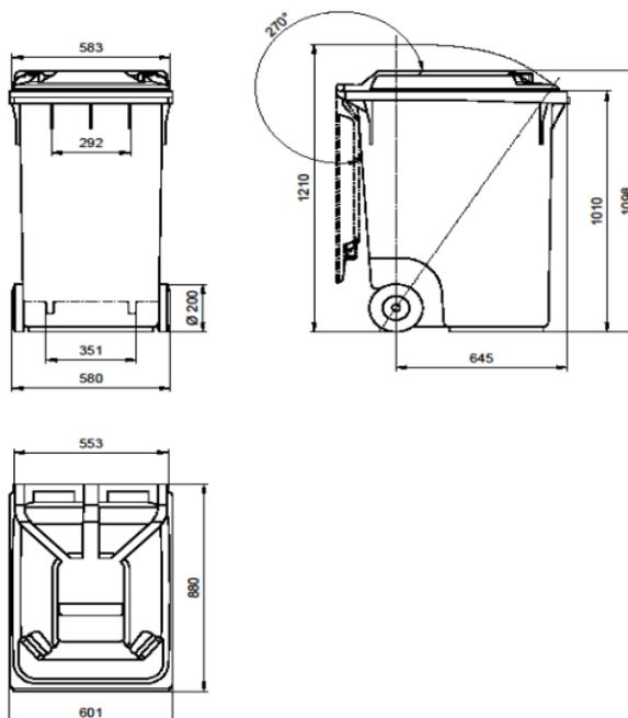
Capacidade nominal: 340 L. Carga útil nominal: 160 kg. Peso morto: 20 kg / 22,5 kg (mit Rad Ø 300 mm).
