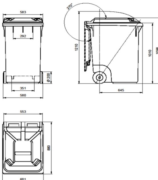
Capacité nominale : 340 L. Charge utile nominale : 160 kg. Poids mort : 20 kg / 22,5 kg (mit Rad  $\varnothing$  300 mm).
