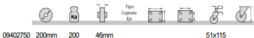
Roulette d'échafaudage pivotante, tube femelle avec frein, de 200 x 50 mm. Roulette spéciale pour échafaudage avec système de freinage.
