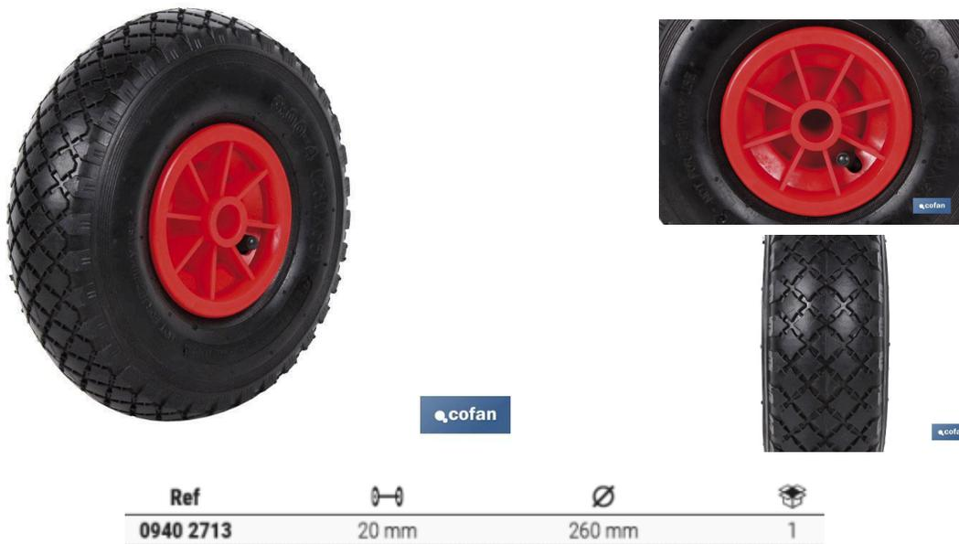
Roda pneumática para carrinho de armazém. Eixo: 20 mm. Largura: 85 mm. Diâmetro: 260 mm. Carga máxima: 80 kg.
