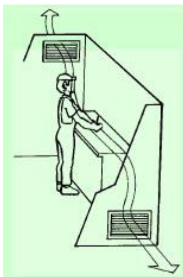
Fig. 7: Sistema de extracción mediante un recinto acotado
