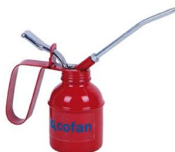
Construcción en acero, con el cuerpo dibujado transparente a partir de lámina revestida de estaño recubierto en polvo de alta calidad. La bomba de metal tiene 2 válvulas para gran volumen. La válvula de aspiración en la parte inferior de la bomba es sin muelle, lo que impide el mal funcionamiento debido a que la válvula se pegue aceite resinoso.
