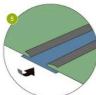
5 Doble los bordes recortados; coloque cinta adhesiva de unión debajo de los bordes.
