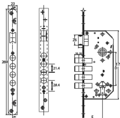
ES Caja y tapa en acero pintada. Frente, cerradero y hierro latonado. Picaporte plano en hierro latonado reversible. Palanca de 4 bulones hierro latonado 2 vueltas. Cerradero cuadrado o redondo. Acabado del frente en color níquel y latón. Contiene tornillos de fijación cerradura y cerradero.
