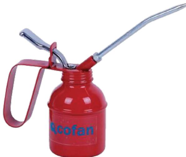
Construction en acier, avec le corps dessiné transparent en tôle étamée à revêtement en poudre de haute qualité. La pompe en métal est équipée de deux vannes pour les grands volumes. Le clapet d'aspiration situé au bas de la pompe est sans ressort, ce qui évite tout dysfonctionnement dû à l'adhérence du clapet à l'huile résineuse.
