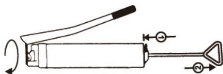
Dévisser la tête en la tournant. Appuyer sur le levier de déverrouillage et tirer le piston.
