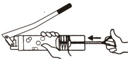
Pousser le piston dans le tube, en chassant l'air.
