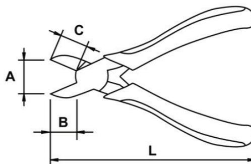
Alicate de corte diagonal, com arestas de corte de precisão, adicionalmente endurecido por indução, dureza aprox. 62 HRC.
