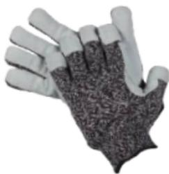
ES Máxima resistencia al corte por cuchilla. Alto nivel de resistencia a la abrasión. Galga 10. Ideal para trabajos pesados. Piel de vacuno sobre palma y dedos.
