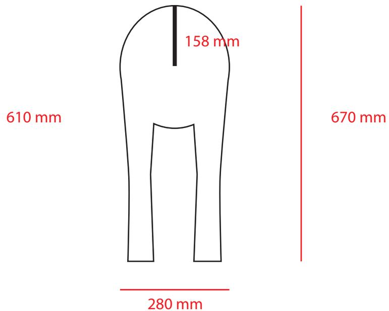
\* El grosor de las hendiduras de ensamblaje de las piezas, dependerá del grosor del cartón para que encaje a la perfección. En nuestro caso, utilizando los cajones de Cofan, hemos necesitado 5 mm.
