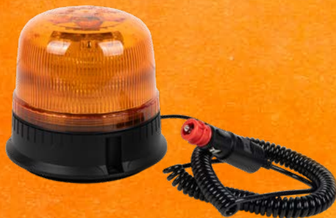
LUZ LED ESTACIONARIA DESTELLANTE ECE R65 CON IMÁN 12/24 V IP66
