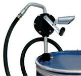
ES Uso recomendado para productos con base petróleo y diésel fuel. No usar con disolventes, productos con base en agua, alcalinos y ácidos. Válidos para bidones de 50-205 litros. Viscosidad máxima: 2000 SSU. Caudal: 38 LPM (10 GPM) @120 RPM.
