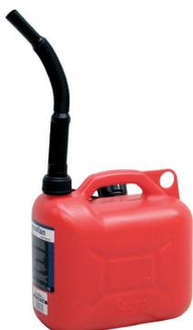
ES BIDÓN fabricado en polietileno reforzado con una densidad superior a 1,2 gr/cm<sup>3</sup>. Válido para todo tipo de petróleos líquidos a excepción del Benceno, Tolueno y Xileno. En caso de temperatura elevada, llenar máximo ¾ partes del bidón. Homologado para RID/ADR.
